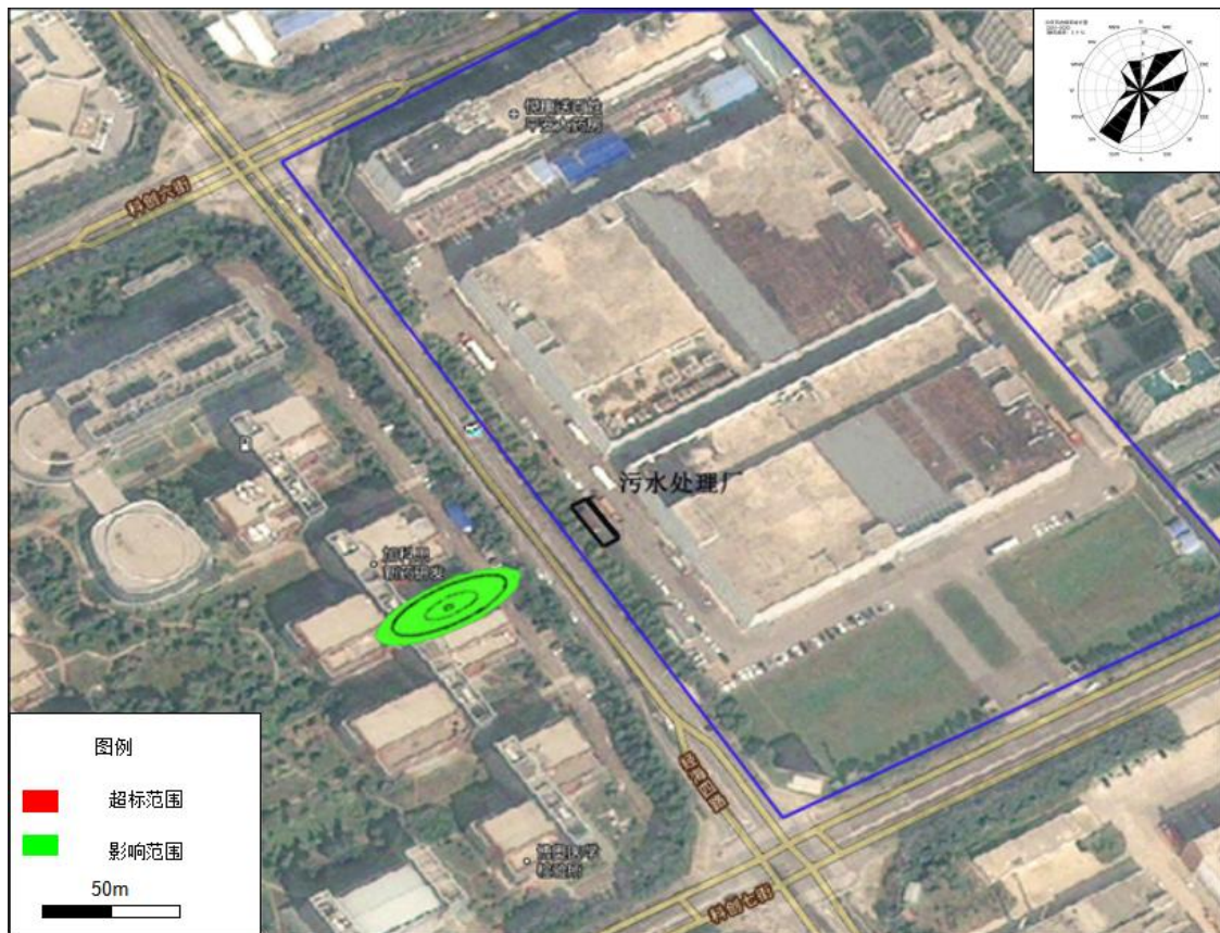
图 7.2.3-8 泄漏污染因子 \text{COD}_{\text{Mn}} 在 1000 天时地下水中浓度预测图
