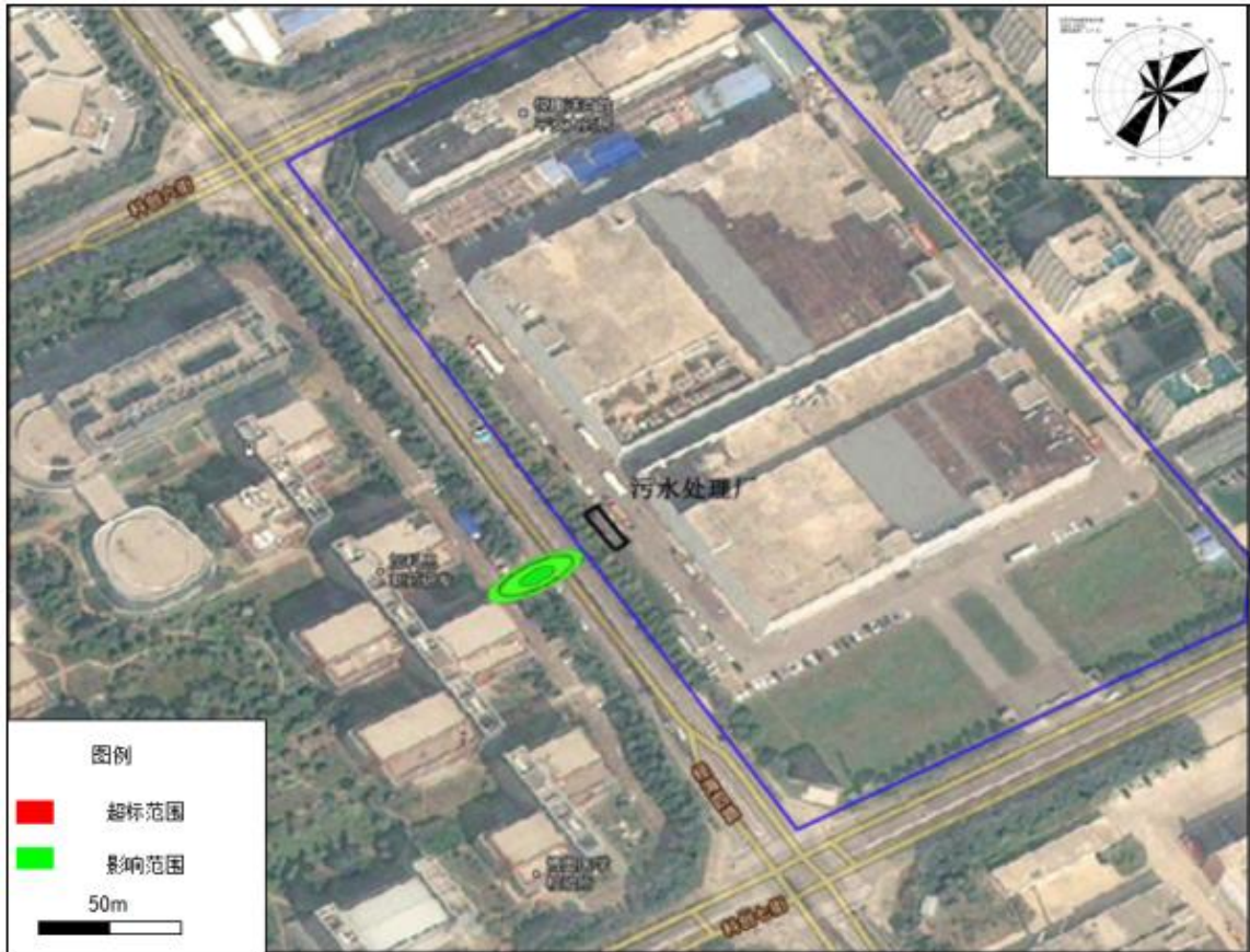
图 7.2.3-8 泄漏污染因子 \text{COD}_{\text{Mn}} 在 1000 天时地下水中浓度预测图
