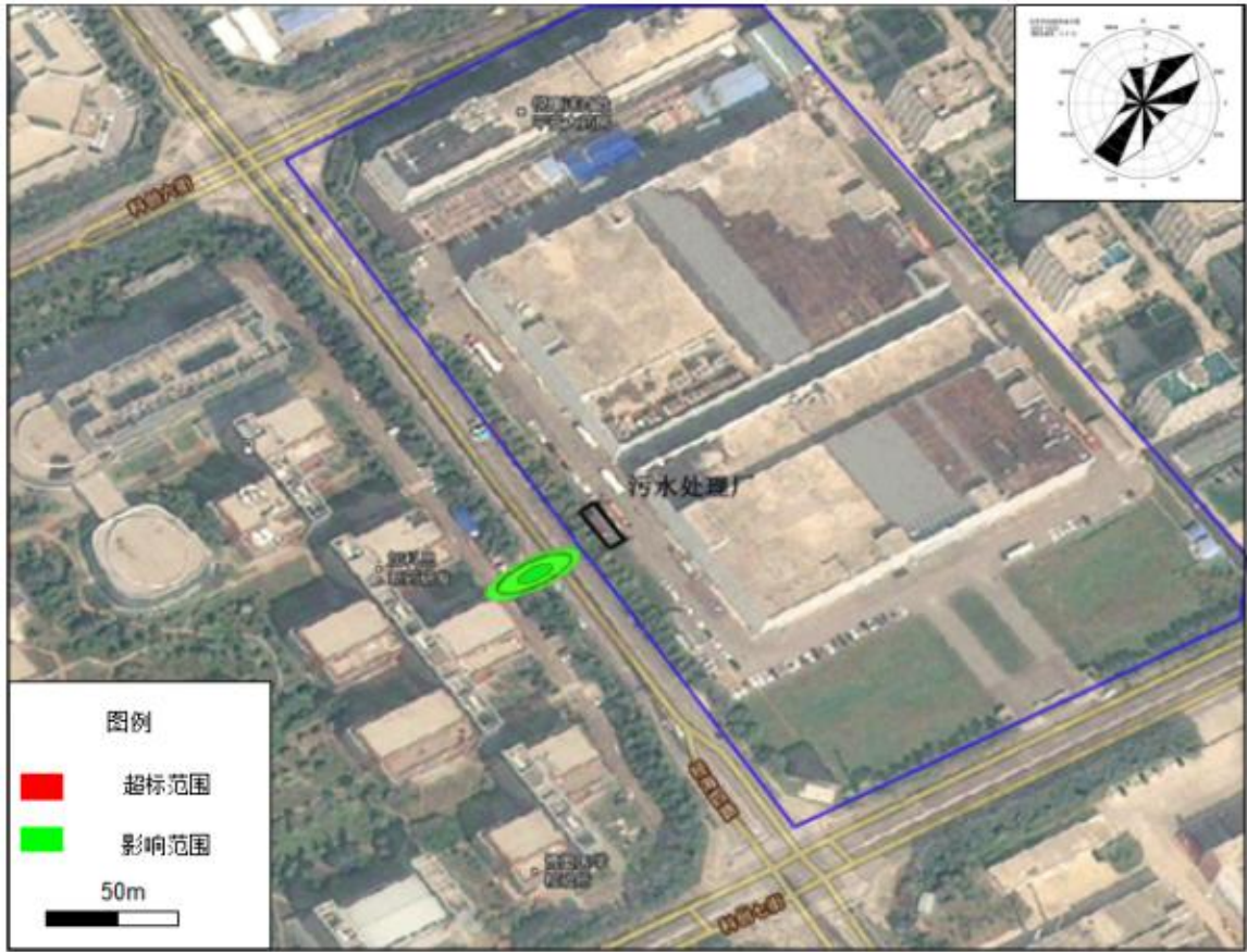
图 7.2.3-12 泄漏污染因子氨氮在 1000 天时地下水中浓度预测图
