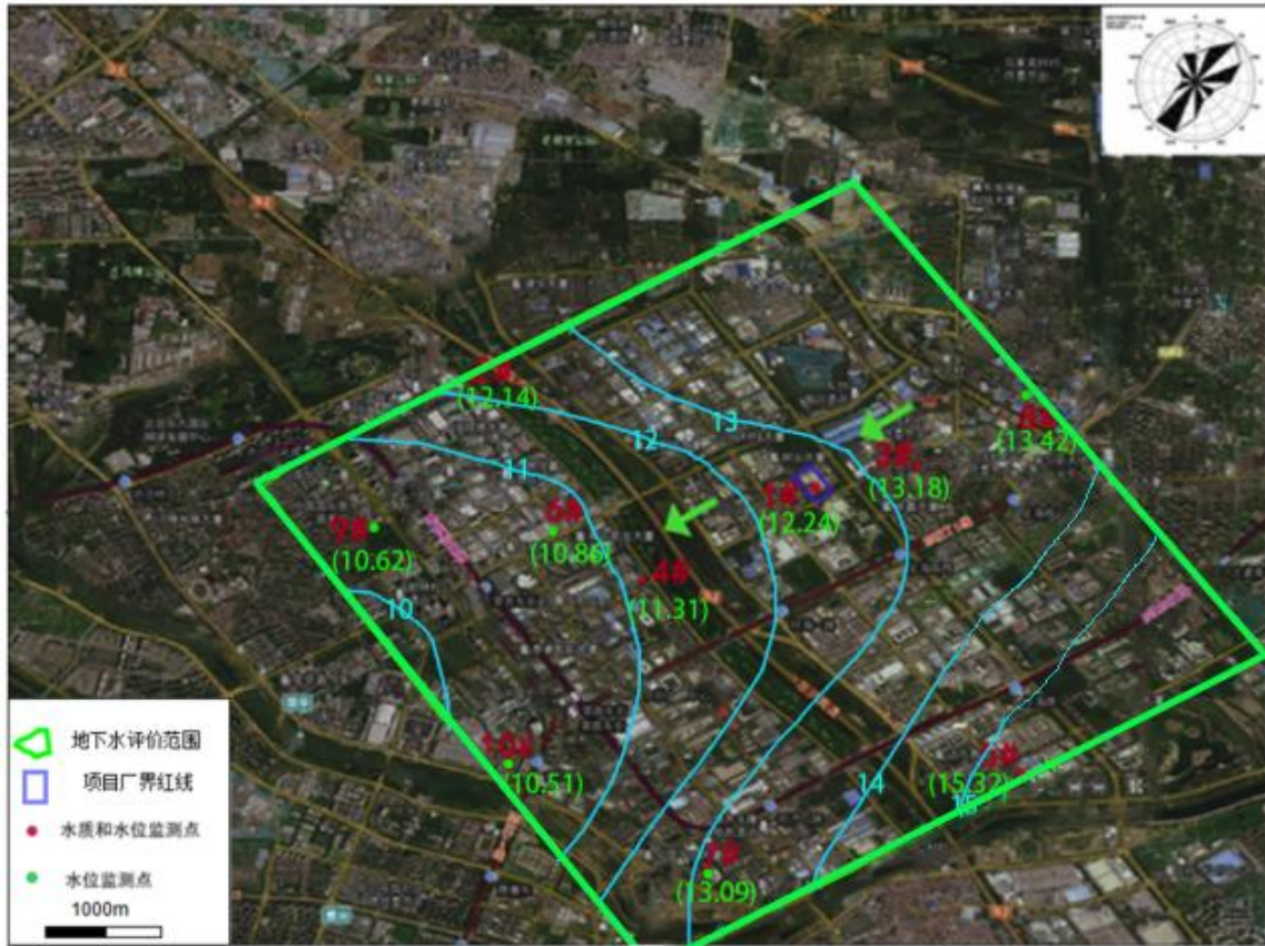
图 6.3.1-1 地下水水质、水位监测点位图
