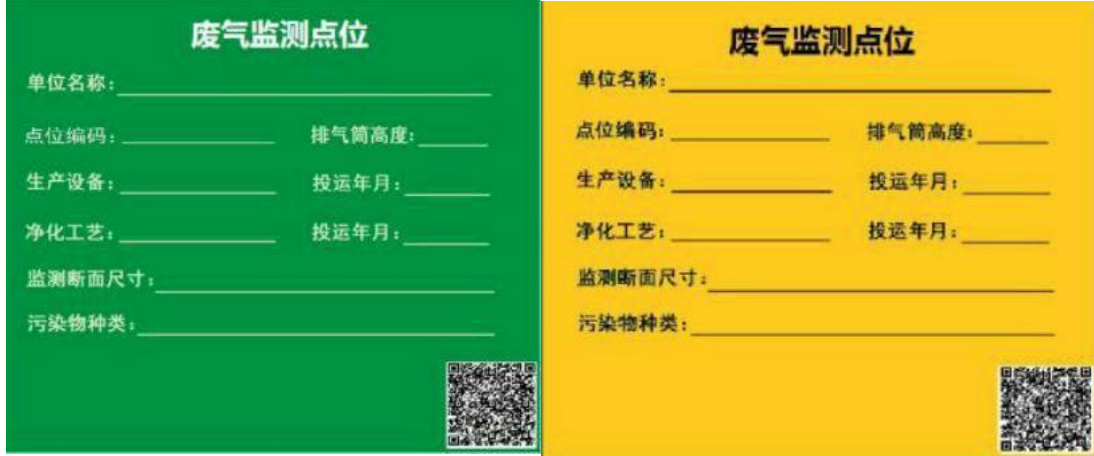
提示性废气检测点位标志牌
