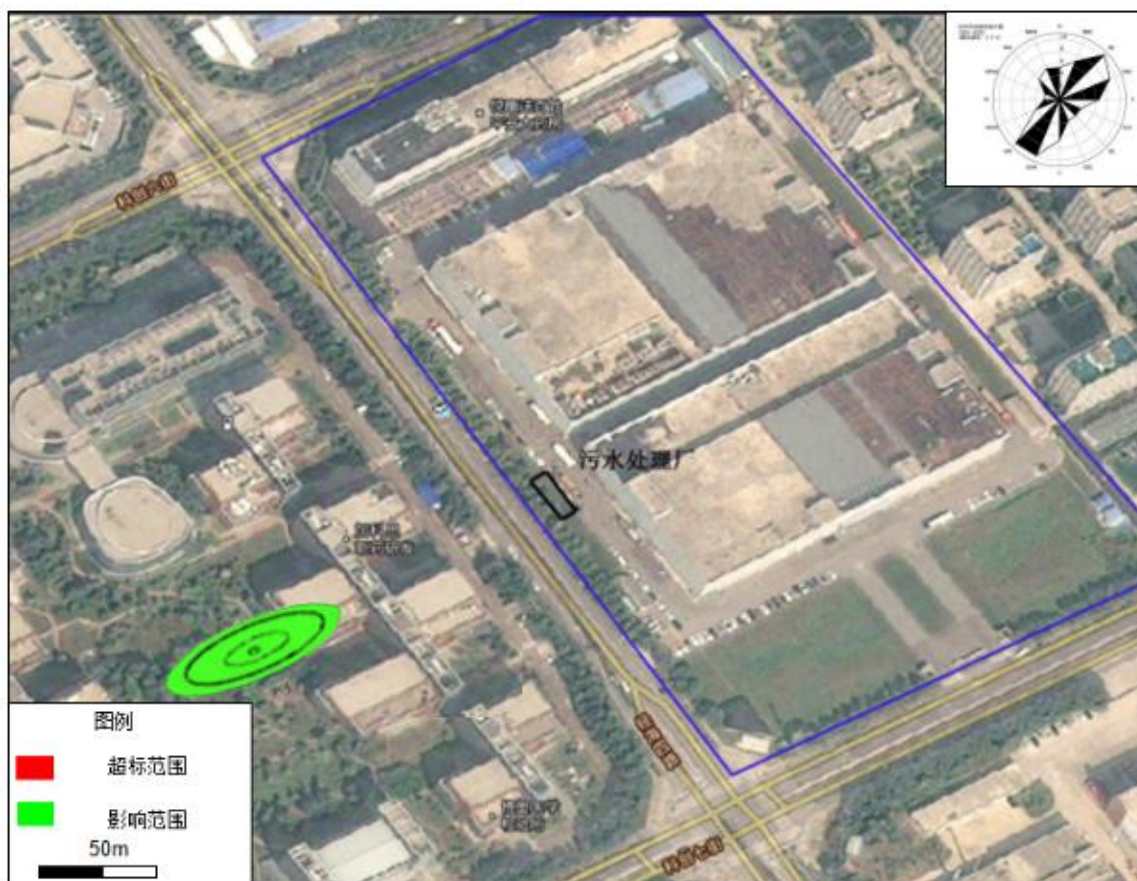
图 7.2.3-14 泄漏污染因子氨氮在 7300 天时地下水中浓度预测图
