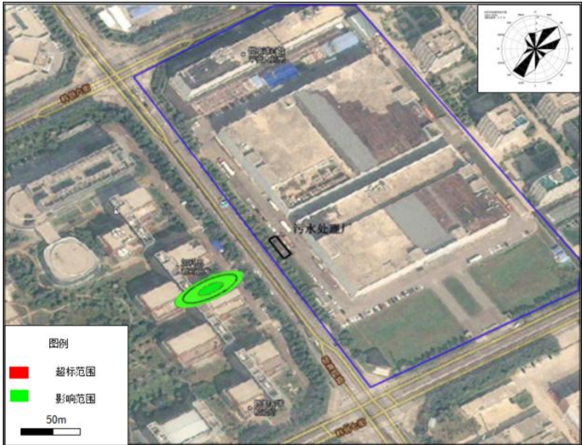
图 7.2.3-13 泄漏污染因子氨氮在 3650 天时地下水中浓度预测图
