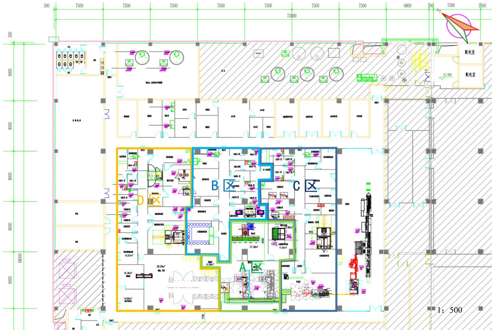
附图 3 本项目非青霉素非头孢类无菌粉针剂生产车间平面布置图
